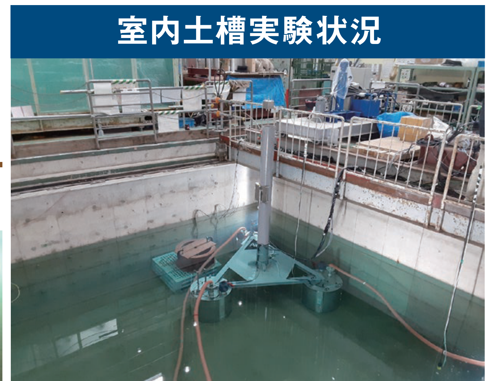
複数脚基礎の水理模型実験
