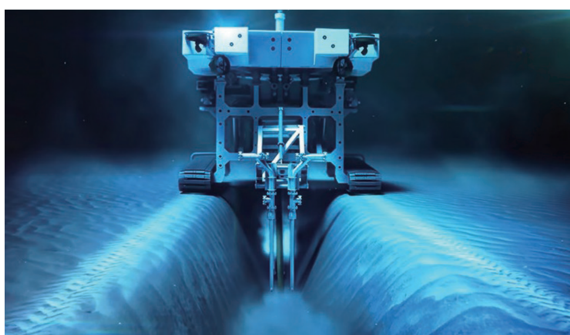
ケーブル埋設施工イメージ (参考) SMD 社より提供
