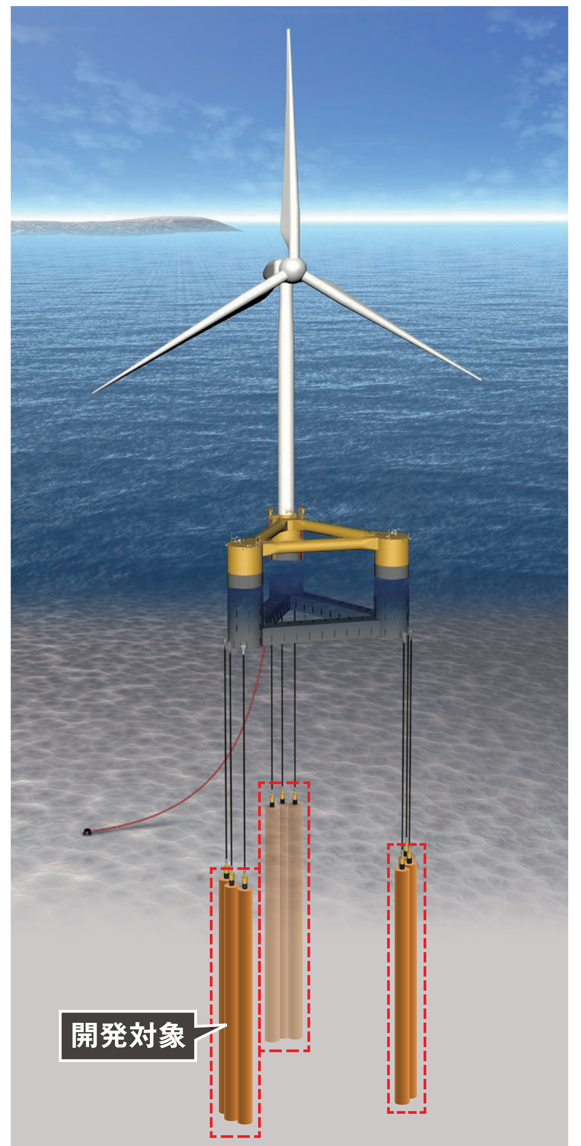
TLP方式の概略図 提供：三井海洋開発株式会社
