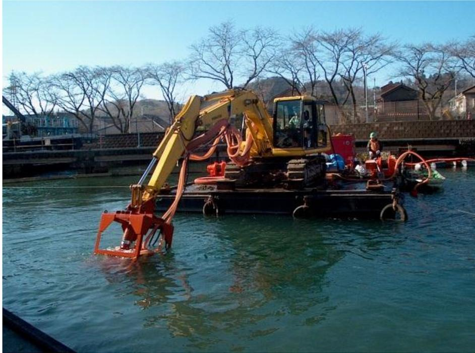
写真-1 底質回収装置
