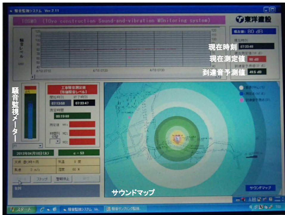
地盤改良工事中の広域監視例（監視画面）
