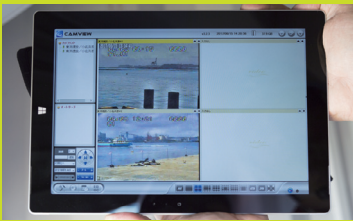
現場付近の海上を通過する船を監視するモニター。岸壁工事に影響を及ぼす航跡波の発生を事前に知らせます。
