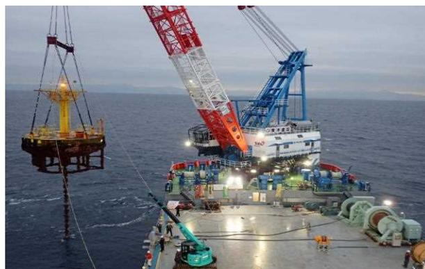
大型海上クレーンに対応した吊荷上下動低減装置の開発 (J-Ocean)
