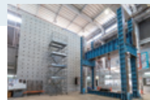
反力壁（左）と加力フレーム（右）
