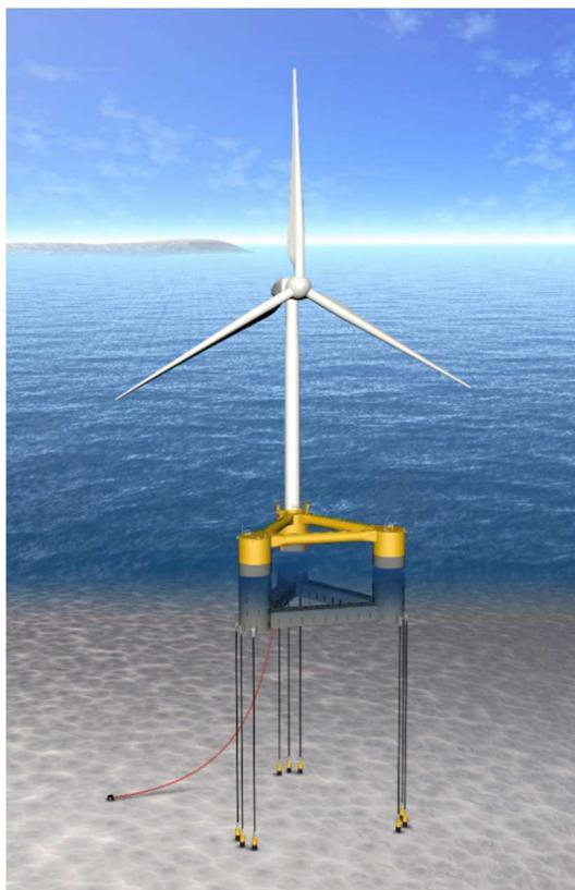
TLP（Tension Leg Platform『緊張係留』）方式の概略図
