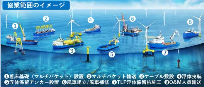
①着床基礎（マルチバケット）設置 ②マルチバケット輸送 ③ケーブル敷設 ④浮体曳航
