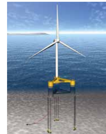
TLP方式の概略図 (三井海洋開発株式会社提供)
