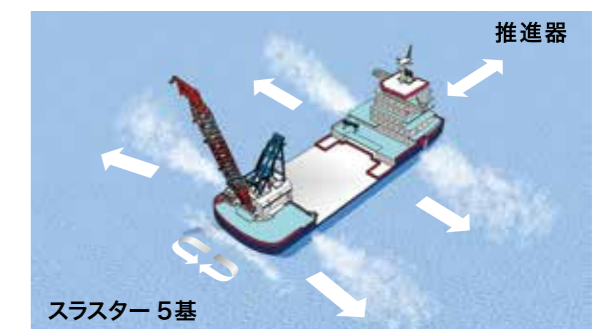
DPS(自動船位保持装置)動作イメージ図
