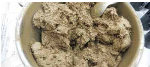
配合材料混合後の補強土
