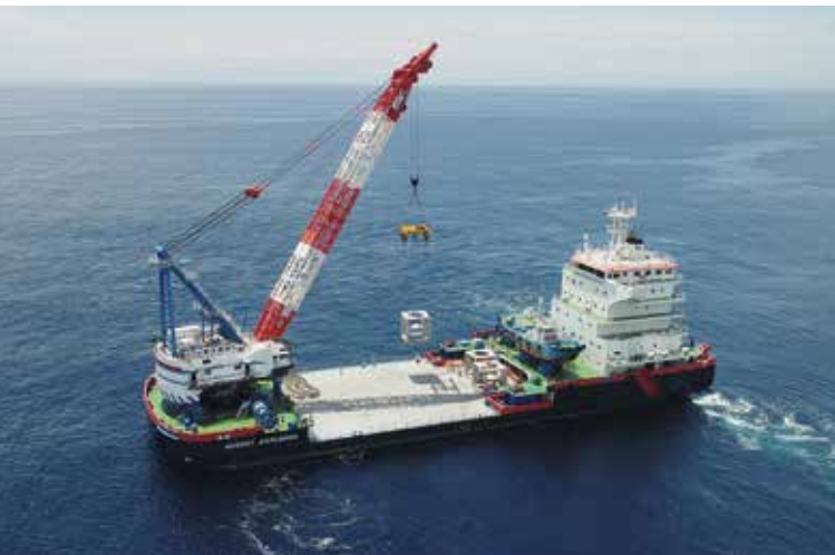
長期無寄港に耐える航海能力、強風時や強い潮流下での作業が可能な最新鋭の定点保持機能を有する「AUGUST EXPLORER」
