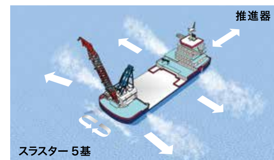
DPS(自動船位保持装置)動作イメージ図
