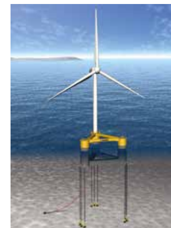
TLP方式の概略図 (三井海洋開発株式会社提供)
