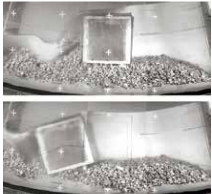
津波越流と防波堤の安定性実験(ドラム型遠心力载荷模型実験装置)
