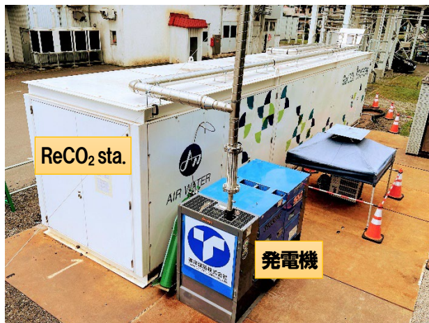
CO 2 回収実験装置 (ReCO 2 STATION と発電機)
