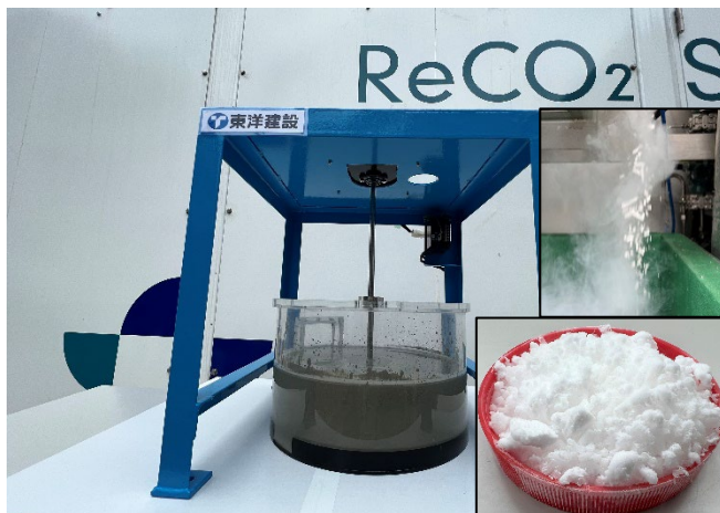
回収したCO 2 (ドライアイス…写真右) をセメントスラリーに固定
