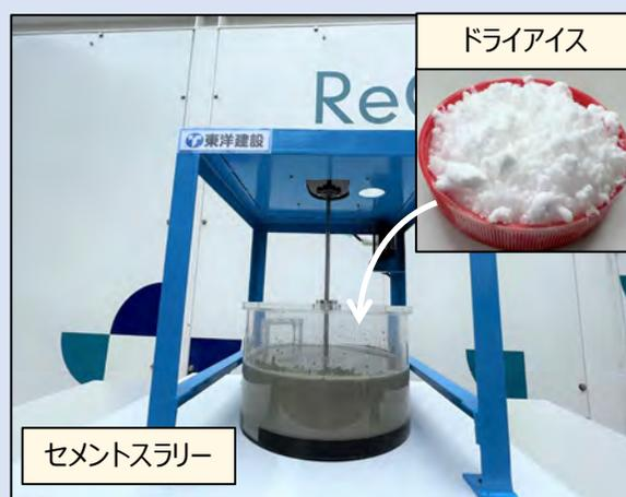
回収したCO<sub>2</sub>（ドライアイス）をセメントスラリーに混入し固定化
