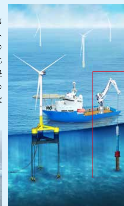
赤枠内:大水深での係留基礎杭の施工実証実験のイメージ
