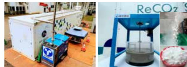
CO 2 回収実験装置 (ReCO 2 STATION と発電機) 回収したCO 2 (ドライアイス) (写真右) をセメントスラリーに固定
