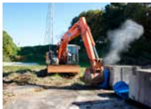
BH旋回時のバケットの衝撃実験
