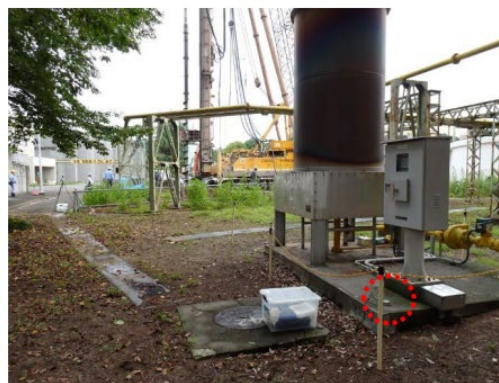
写真 2.2 振動測定：V2（発生源から 28m）
