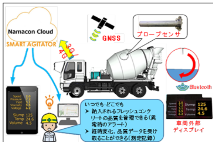
参考図 プローブシステムの概要
