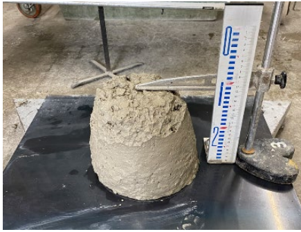
コンクリートのスランプ試験
