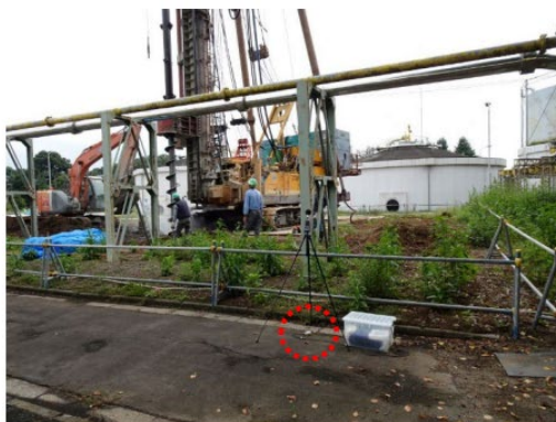
写真 2.1 振動測定：V1（発生源から 18m）
