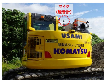
写真 3.2 ANC サイレンサー効果測定状況
