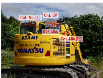
写真 3.1 ANC サイレンサー設置状況
