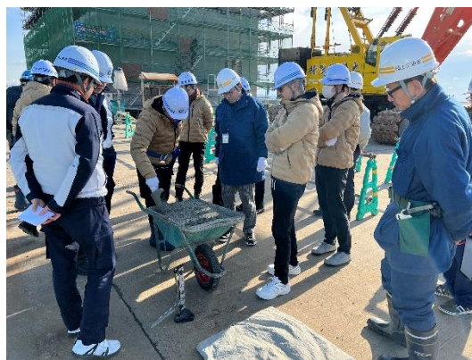
高流動化コンクリートのフレッシュ性状を確認している様子
